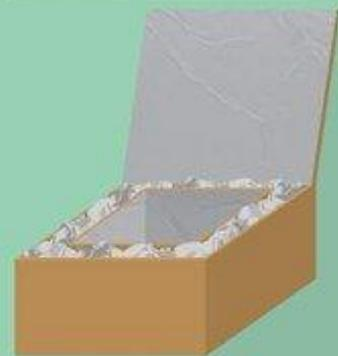
**4** Obložite jednu stranu kartonske ploče aluminijskom folijom i pričvrstite je trakom na poklopac veće kutije. To će služiti kao reflektor sunčeve svjetlosti.
